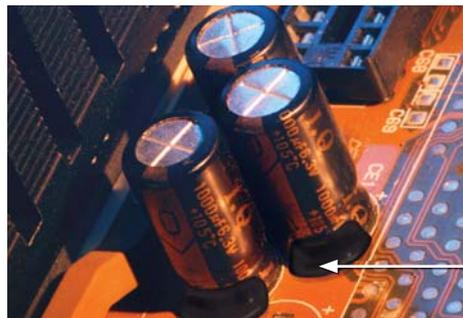
Proteção de vibração de componente eletrônico soldado, como exemplo um capacitor
