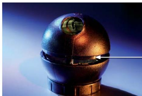
Colagem / selagem de uma carcaça de uma câmera automotiva. Cola aplicada dentro dos espaços
